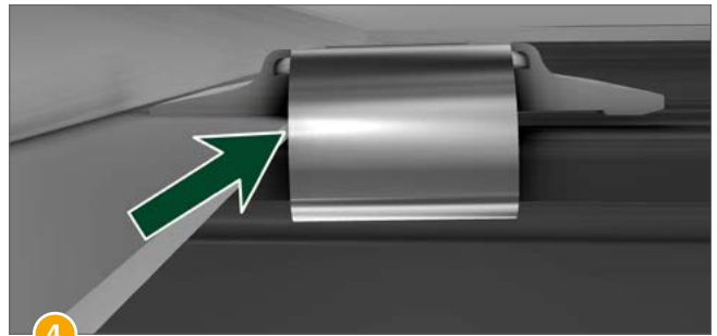
4 Schieben Sie die Klemmspanne so weit wie möglich an den Modulrahmen.
