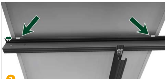
5 Der Potentialausgleich muss mindestens über zwei Erdungspins pro Modulrahmen erfolgen.
